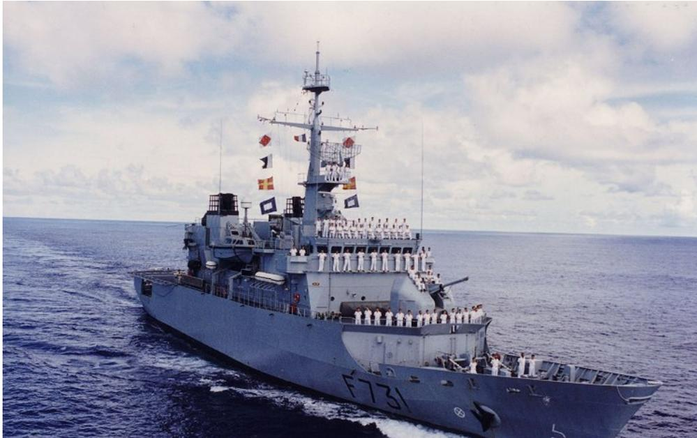
Deuxième d'une série de six frégates de surveillance, commandées en 1989, le *Prairial* a été construit par les Chantiers de l'Atlantique à Saint-Nazaire, selon des normes de construction utilisées pour les navires de commerce. Cette frégate est mise sur cale le 11 septembre 1990, et lancée le 16 mars 1991. Ses armes et équipements militaires ont été installés par DCN Lorient. Le bâtiment est entré en service le 20 mai 1992 et est arrivé à Papeete en juin 1992.
